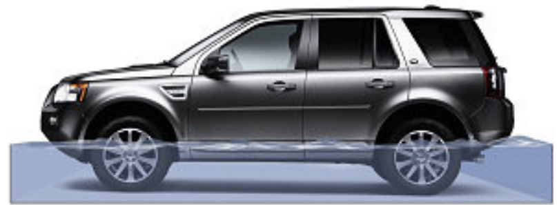
Wading Depth Maximum wading depth 19.7 inches
